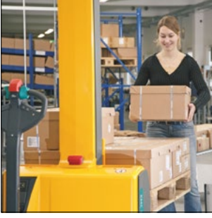
Ergonomik bel destekli yükleme için kaldırma masası olarak kullanım
